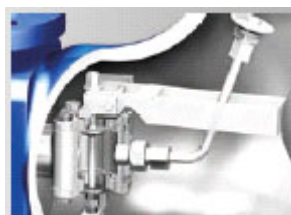
Двосідельна версія для високої пропускної здатності (до 10000 кг/год) та оптимізованого зусилля на важелі, а також вбудований термостатичний елемент для відведення повітря
