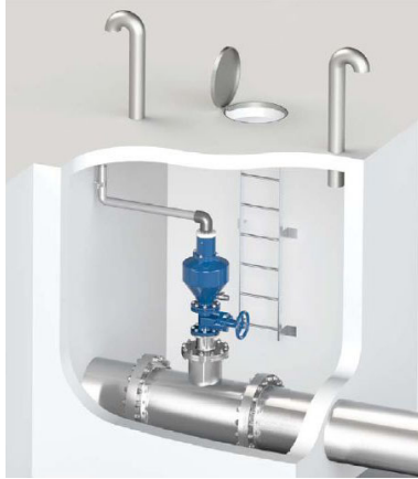
мал.28 Приклад встановлення клапанів з відводом SUB.
