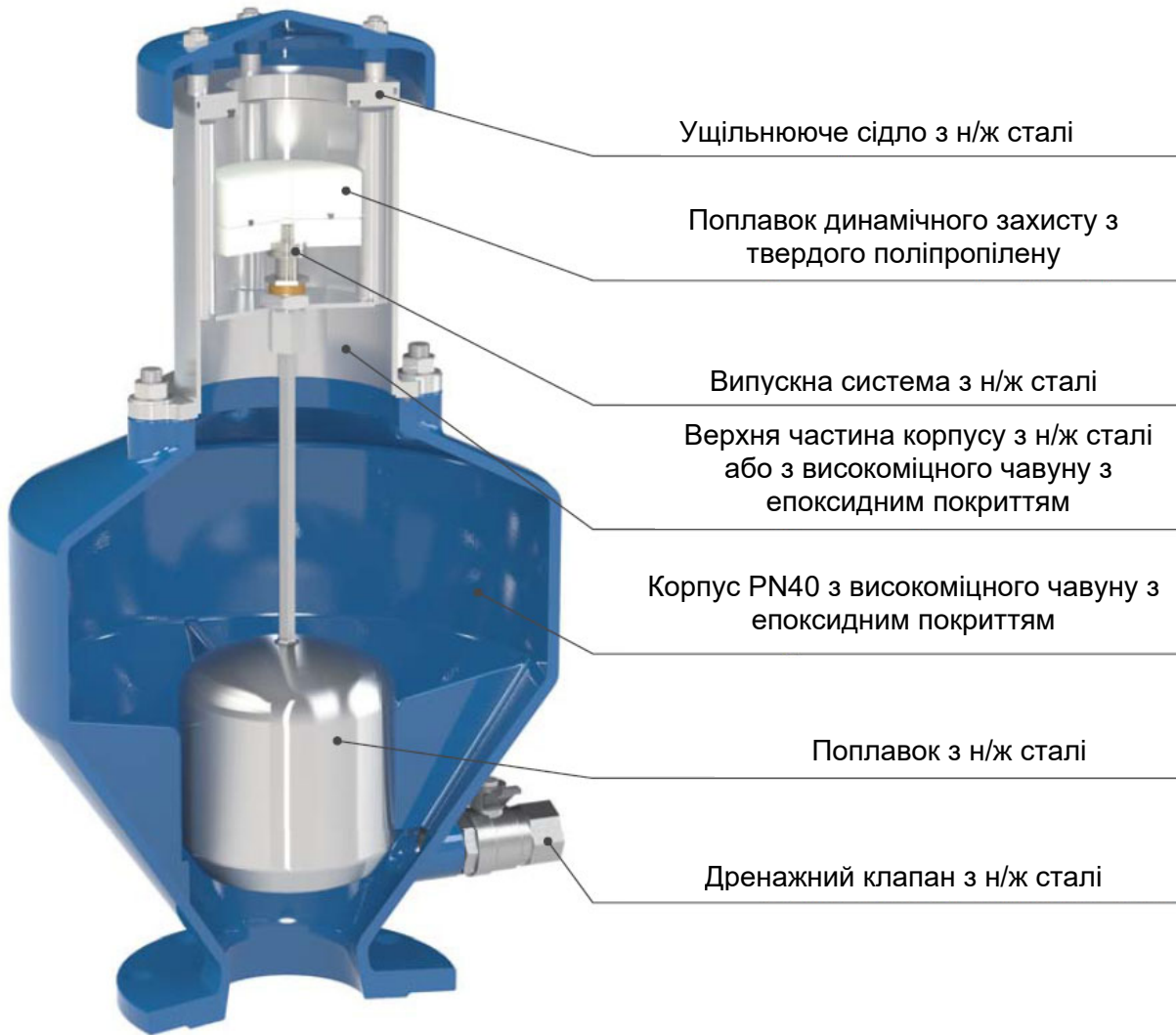
мал.8 Конструкція клапана для систем каналізації, модель SCF-RFP
