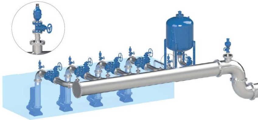
мал.23 Компактні клапани CSA SCA 2" з механізмом AS встановлені на виході заглибних насосів, а також в кінці колектора модель SCF-AS.
