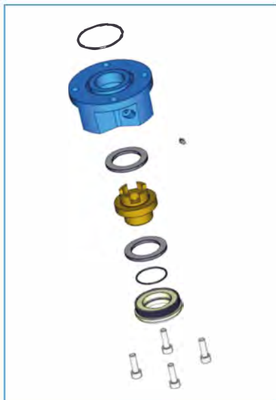
ISO втулка тип А з упорними підшипниками
