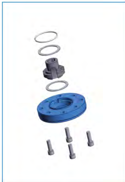
ISO втулка тип В3/84 без упорних підшипників
